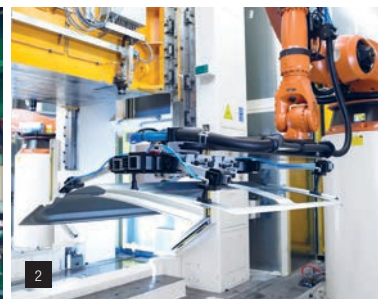
1 2 Bomba de vacío LEMAX+ y ventosas de alto rendimiento de serie C para la toma de piezas estampadas
