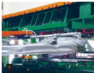
1 2 Bomba de vacío LEMAX+ y ventosas de alto rendimiento de serie C para la toma de piezas estampadas
