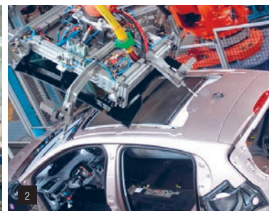
2 Bombas de vacío GVMAX y ventosas con rótulas VPYR para la toma de piezas acristaladas.
