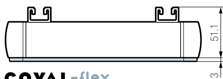
pletina "COVAL-flex" espesor 3mm
