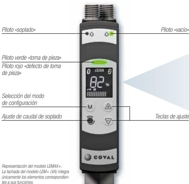
Representación del modelo LEMAX+. La fachada del modelo LEM+ (VA) integra únicamente los elementos correspondientes a sus funciones.
